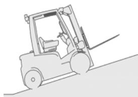
En cada ejercicio deberá mostrarse un correcto control sobre la velocidad y el frenado del vehículo, así como una correcta acometida de la rampa, todo en sentido ascendente y descendente.
