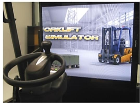
Del mismo modo, podemos sensorizar joysticks o palancas de control de máquinas reales. En el simulador de la imagen se han utilizado palancas originales Jungheinrich.
