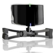
Opcionalmente, para aumentar la sensación de profundidad y facilitar la gestión de las vistas de la pantalla, el simulador puede integrar un Tracker. Este dispositivo detecta y amplifica los movimientos de la cabeza del usuario, de modo que, por ejemplo, una pequeña inclinación hacia abajo de la cabeza, acompañada de un leve movimiento hacia adelante, modifica la vista de modo que se muestren en pantalla las horquillas de la máquina.
